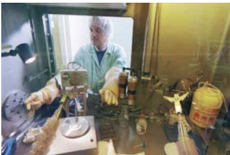
Préparation par l'ouverture arrière d'une enceinte de production de FDG montrant l'outillage présent dans la cellule.
