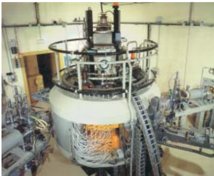
Cyclotron 35 MeV pour la production de radionucléides (Thallium 201, Iode 123 et Indium 111) (équipement IBA).
