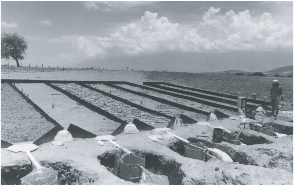
► Figure 3. Dispositif de mesure du ruissellement (d'après Scopel/Findeling)
