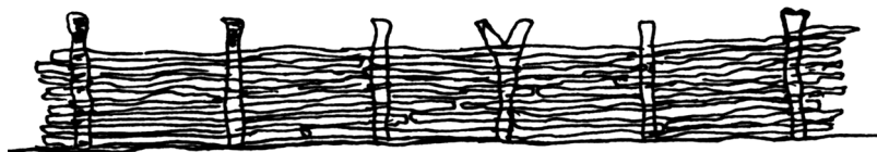
► Figure 5 : Fascine en branches
